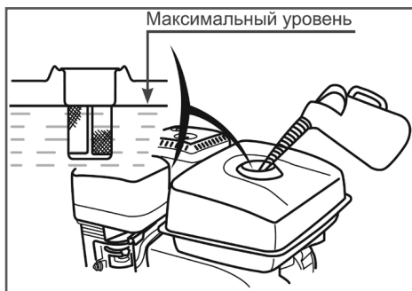
Рис. 5 Максимальный уровень топлива в топливном баке
