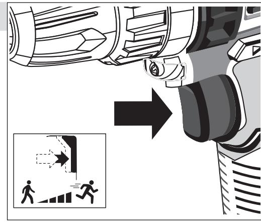
**9. Доворачивание крепежа с блокировкой шпинделя**
