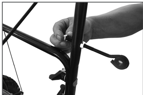
Рис. 13 Монтаж кронштейна рычага поворота желоба
