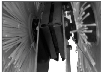
Рис. 4 Установка соединительных пластин крепления отвала
