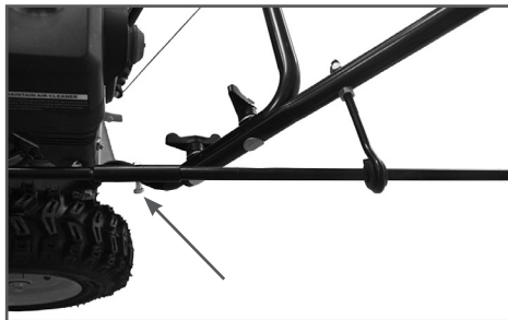
Рис. 14 Соединение верхней и нижней половины рычага поворота желоба
