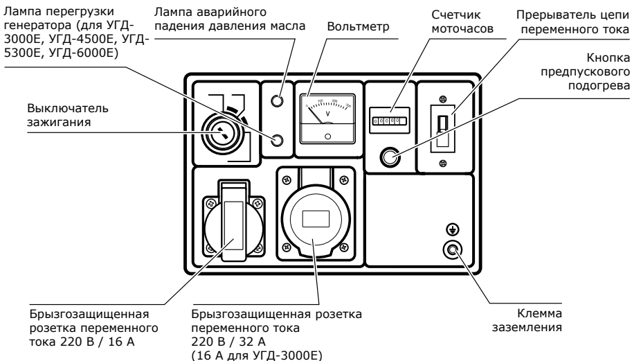
Рис. 2. Схема панели управления генераторов УГД-3000Е, УГД-4500Е, УГД-5300Е, УГД-6000Е, УГД-7500Е, УГД-8500Е.
