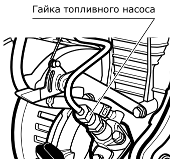
Рис. 16 . Удаление воздуха из топливной системы двигателя
